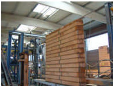
**Abb. 1:** Maschinelle Vorfertigung der Mauertafel im Werk
